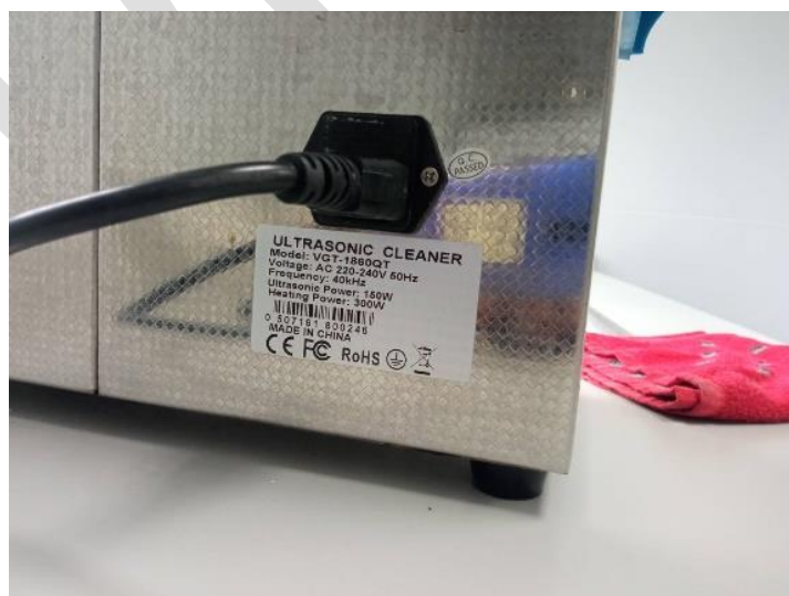
รูปที่ 10.2 อุปกรณ์ไฟฟ้าในห้องปฏิบัติการที่มีสัญลักษณ์สายดิน
